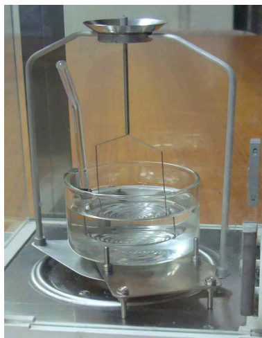
그림 7. 밀도시험에 사용한 장치 예시
