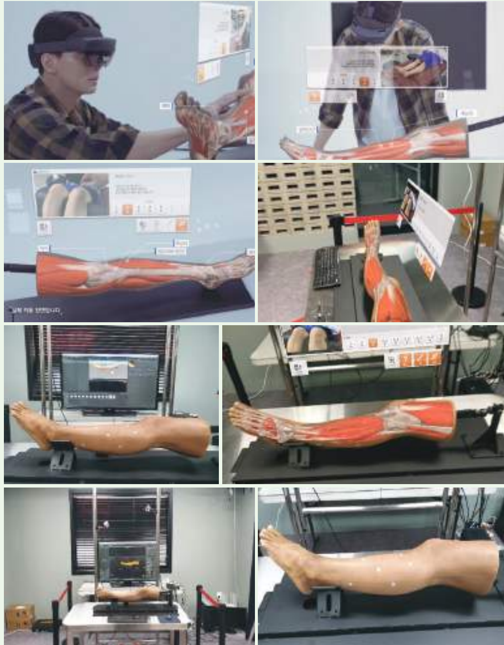
트래커를 이용한 더미에 3D 모델 맵핑용 시스템 적용
